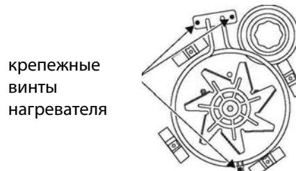
Снимите фиксаторы, при помощи которых нагреватель крепится внутри духовки, и осторожно выньте его.
